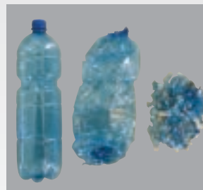
Gebindeverdichtung je nach Anforderung, unkompaktiert, kompaktiert, geschreddert
